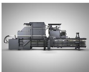
внутренние поверхности камеры прессования, и стенки канала прессы усилены листами износостойкой стали XAR 500
