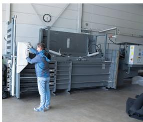
Оптимальная защита пользователя инфракрасным датчиком, реагирующим на движение в зоне закрытия/открытия прижимных плит
