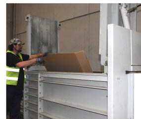
Благодаря просторному загрузочному окну, заполнение прессовой камеры материалом становится простым и удобным
