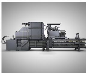
в качестве опции доступен в версии с частотно-регулируемым гидравлическим приводом (экономия до 40 % электроэнергии при неизменной производительности)
