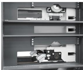
Высокопрочная и легкая в обслуживании система направляющих роликов прессовой плиты
