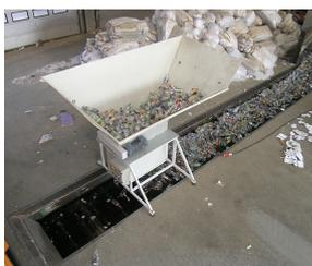
Возможность перфорирования пустых и/или заполненных ПЭТ-бутылок (макс. 2,5 л) с крышками и без крышек
