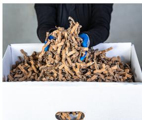
Изготовление картонных чипсов для использования в качестве упаковочного наполнителя. Картонные чипсы фиксируют товар в упаковке, заполняют пустоты и смягчают удары. И всё это без...
