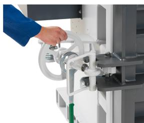
Замок-маховик - Простой в использовании благодаря ключ для облегчения открытия при прессовании расширяющихся материалов
