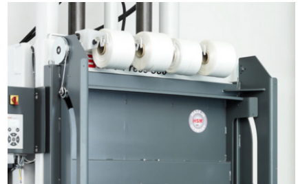
Umreifung des Ballens mit Draht - Optional mit Bandstation zur wahlweisen Abbindung mit Polyesterband oder Draht verfügbar
