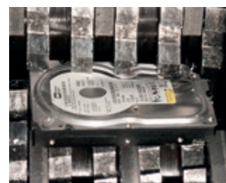
Wytrzymałe, hartowane indukcyjnie wałki tnące z litej stali gwarantują długotrwałą eksploatację!
