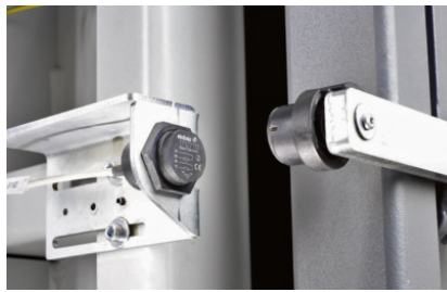
Automatische start van het persproces na het sluiten van de deur
