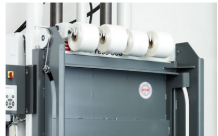
Omwikkeling van de baal met draad - optioneel met bandstation voor keuze van afbinden met polyesterband of draad beschikbaar
