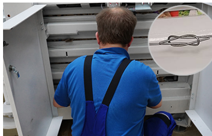
Handmatige balenafbinding met met draad
