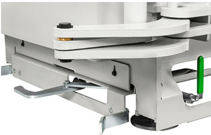
Palletvergrendeling voor een veilige baaluitname
