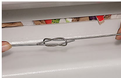
Handmatige balenafbinding met Quick-link-draad
