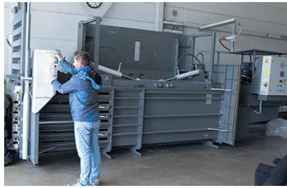
Het infrarood lichtscherm zorgt voor optimale bescherming van de bediener
