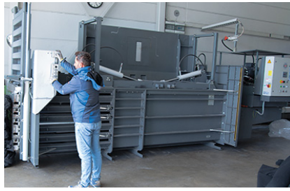
Het infrarood lichtscherm zorgt voor optimale bescherming van de bediener
