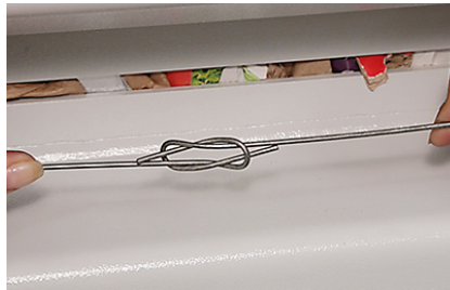
Handmatige balenafbinding met Quick-link-draad
