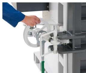
Handwielvergrendeling - Eenvoudig te bedienen omdat de tegengesteld schroefdraad zorgt voor snel openen en sluiten
