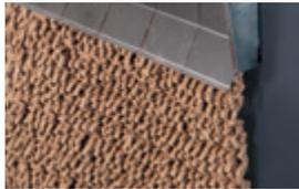
Produção de material de preenchimento comprimido com aba de compressão fechada (HSM ProfiPack P425).
