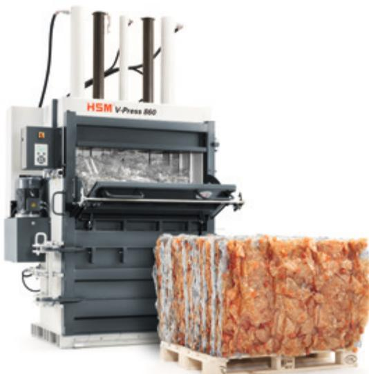
**La prensa vertical HSM V-Press 860 P ha sido especialmente diseñada para presar botellas PET abiertas o perforadas.**
