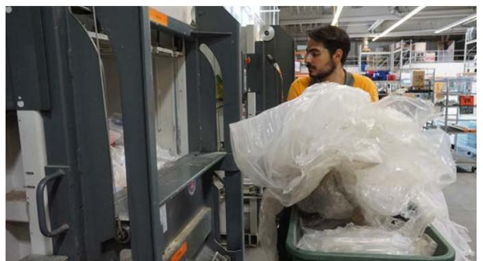
Befüllen einer HSM V-Press 860 mit Folie
