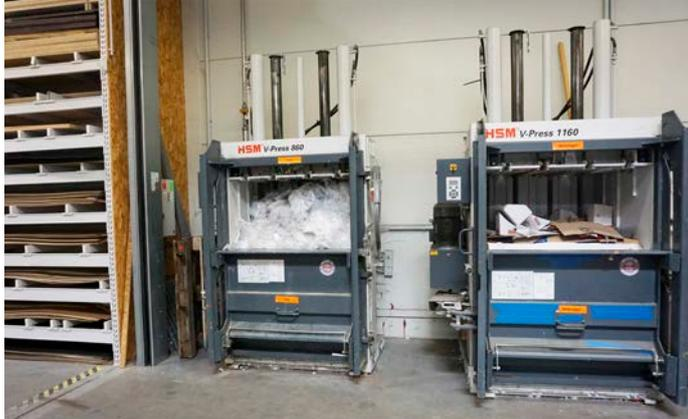
Vertikale Ballenpressen HSM V-Press 860 und 1160
