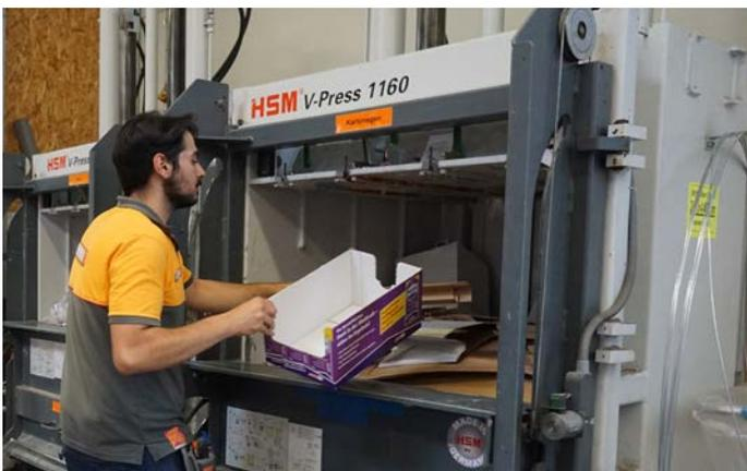
Befüllen einer HSM V-Press 1160 mit Kartonage
