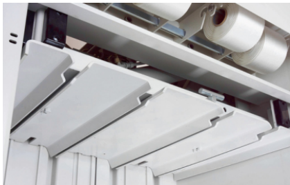
Piano pressante solido ed estremamente stabile grazie alle molteplici guide
