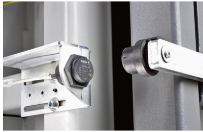
Avvio automatico della compressione dopo la chiusura dello sportello
