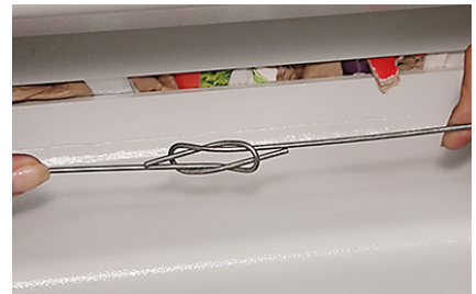
Legatura manuale delle balle con filo metallico Quick-Link
