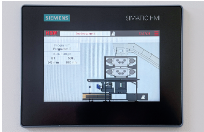
Moderna unità di controllo SPS per il controllo integrato di tutti i componenti dell'impianto.
