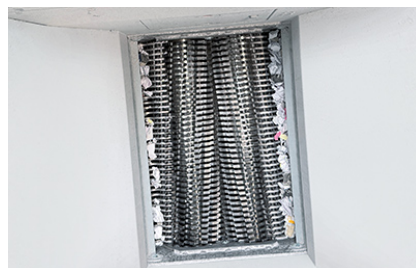
2° livello post-triturazione con sistema a due alberi.
