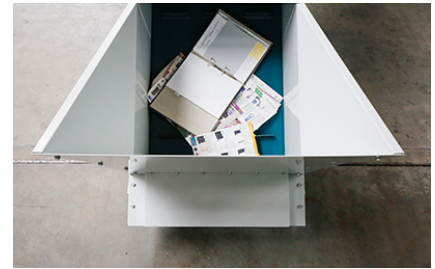
Bocchetta di riempimento stabile con protezione anti sovra alimentazione per il controllo del distruggidocumenti e del nastro trasportatore.
