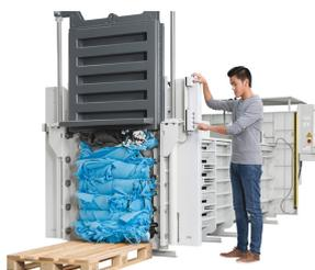
Massima protezione dell'operatore grazie barriera con fotocellule a raggi infrarossi
