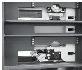
Solida guida del carrello pressante con facile accesso per la manutenzione
