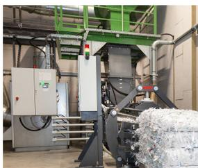
Per un carico continuo con nastro trasportatore o con impianti d'aspirazione
