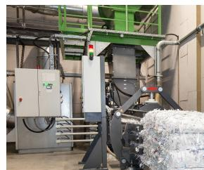
Per un carico continuo con nastro trasportatore o con impianti d'aspirazione
