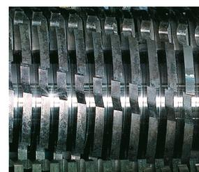
I rulli di taglio in acciaio massiccio temprati ad induzione sono molto robusti ed assicurano la massima durezza.
