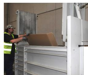
Ampla apertura di carico dimensionata per materiali ingombranti
