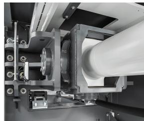
Supporto del cilindro principale con sistema cardanico - Usura ridotta del cilindro e delle guide del piano pressante
