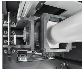
Supporto del cilindro principale con sistema cardanico - Usura ridotta del cilindro e delle guide del piano pressante
