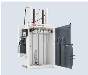
Speciali profili nella porta di espulsione, nello sportello di carico e nel piano pressante permettono di formare la balla con le cavità per essere inforcate senza l'utilizzo del pallet
