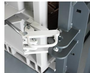
Serraggio idraulico dello sportello - Comoda operazione di apertura e chiusura, nessuno sforzo manuale richiesto
