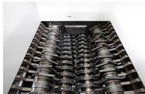
Degré 1: pré-broyage à l'aide d'un système à quatre arbres composé de deux arbres d'admission et de deux arbres de coupe.
