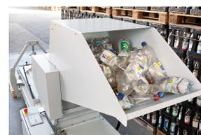
Le système efficace de recyclage PET réduit en un seul cycle de travail le volume des bouteilles PET vides jusqu'à 90 % et les transforme en balles compactes de matière première
