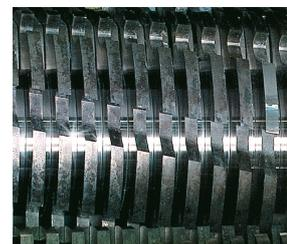
Les cylindres de coupe en acier trempé sont robustes et assurent un niveau de garantie élevé.
