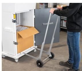
Le chariot d'éjection permet une évacuation simple et une élimination aisée des balles de matériaux compactés.
