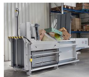
Porte contrepression hydraulique pour l'évacuation des balles pour un confort et une sécurité d'utilisation supérieurs
