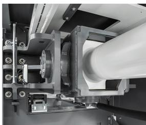
Vérin de poussée du fil de ligaturage monté sur cardan - Usure réduite du vérin de poussée du fil de ligaturage et des guidages du plateau de compactage
