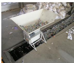
Perforation des bouteilles vides/ou pleines (env. 2,5 litres max.), avec ou sans bouchon
