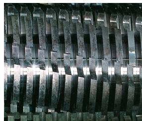
Los rodillos, de sólido corte de acero endurecido por inducción son robustos y garantizan un alto nivel de durabilidad.
