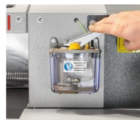
Les combinaisons destructeur-presse avec un système de coupe en particules disposent d'un huileur manuel. Ainsi vous avez la garantie d'un rendement de coupe élevé et constant.
