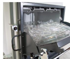
Chargement simple grâce à la trappe de remplissage à une hauteur de travail confortable.
