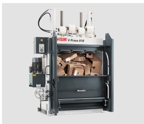
Pour remplir la presse, la moitié supérieure de la porte est tirée vers le bas et s'ouvre automatiquement après le cycle de compactage
