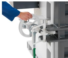
Verrouillage par volant - Facile à manipuler grâce à filetage inversé pour la rapidité d'ouverture et de fermeture
