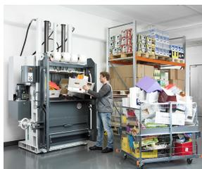
Pour remplir la presse, la moitié supérieure de la porte est tirée vers le bas et s'ouvre automatiquement après le cycle de compactage
