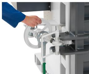
Verrouillage par volant - Facile à manipuler grâce à filetage inversé pour la rapidité d'ouverture et de fermeture
