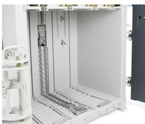
Dispositif d'éjection mécanique, particulièrement robuste
