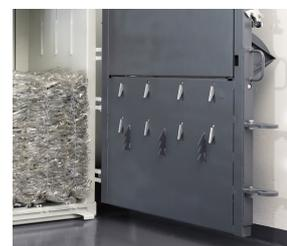
Le nombre des crochets de retenue est doublé afin d'optimiser le compactage du matériau pressé et réduire le processus de chargement
