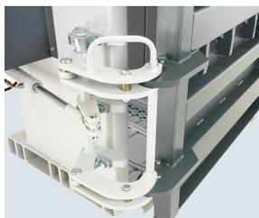
Caisson de compactage et verrouillage hydraulique - Convivialité de l'ouverture et de la fermeture, sans effort manuel à fournir
