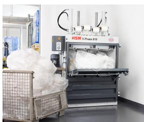
Pour remplir la presse, il faut faire pivoter la moitié supérieure de la porte vers la droite - Lancement automatique du cycle de compactage après la fermeture de la porte
