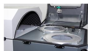
La buse de nettoyage à air comprimé intégrée permet un nettoyage facile de la cartouche filtrante permanente.
