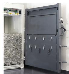
Le nombre des crochets de retenue est doublé afin d'optimiser le compactage du matériau pressé et réduire le processus de chargement
