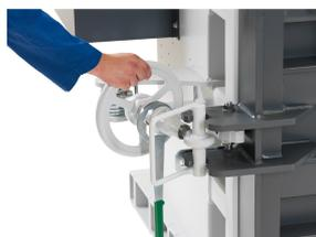
Verrouillage par volant - Facile à manipuler grâce à filetage inversé pour la rapidité d'ouverture et de fermeture
