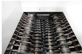
Primer nivel de pre-trituración con sistema de cuatro ejes formado por dos cilindros de entrada y dos de corte.
